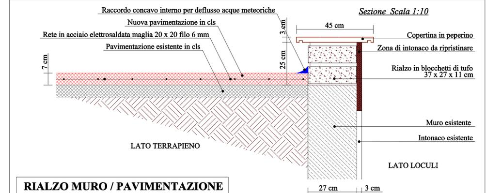
RIALZO MURO / PAVIMENTAZIONE
